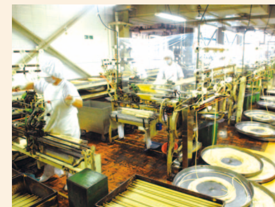
素麺製造の様子。「ほそめ」と呼ばれる工程で、紐状のものを5回に分け、細い棒状へと撚りをかけながら延ばしていく。
